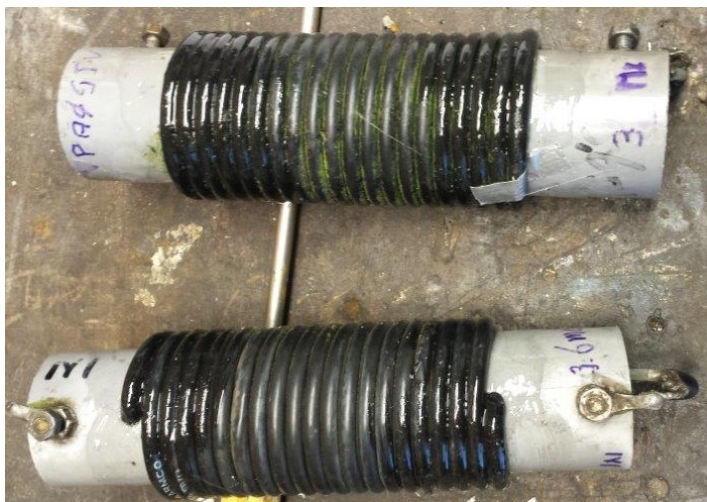
De 3600 kHz traps zijn nog gemaakt op 40mm PVC buis en hebben 20 windingen.
