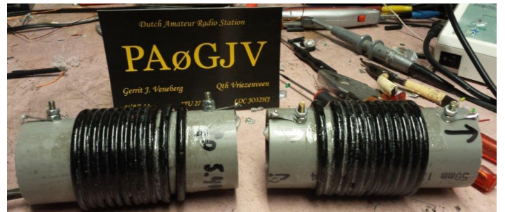
De 5400kHz Coax traps gereed en gefixeerd. Pijl geeft de element richting aan.
