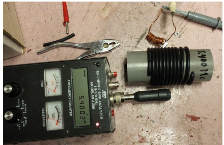
Coax trap aansturen met bv MFJ analyzer en daarboven zie je de oppikspoel
